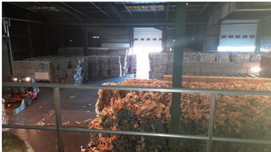
8. *Mise en balles et stockage.* Un fois le tri effectué, les déchets tombent dans des alvéoles et sont envoyés vers la presse à balles. La presse compacte les déchets en cube, dont le poids varie entre 500 et 1.200 kg selon la matière. Ces balles sont ensuite stockées avant leur expédition par camions vers les usines de recyclage qui leur donneront une nouvelle vie.
